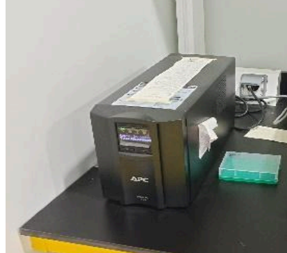
Pemakaian UPS untuk Alat Laboratorium
